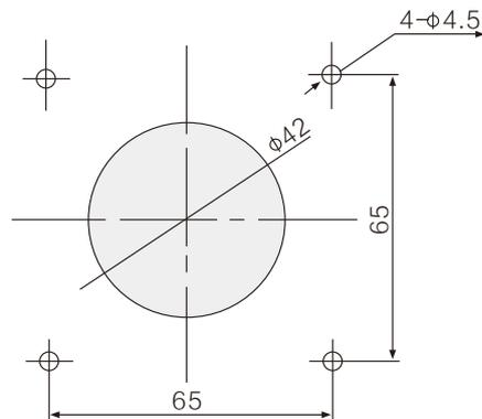
安装F型手柄门板开孔尺寸
